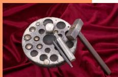
1) Embutideira em aço com orifícios rebaixados, de vários tamanhos. O ourives, com auxílio de embutidores e martelos, consegue obter uma peça oca e convexa a partir de uma chapa espalmada.
