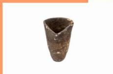
3) Cadinho em cerâmica refratária preparado para suportar altas temperaturas. Objeto destinado a ir à forja para fundir o metal.
